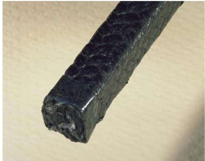
Uma combinação de fios de fibra de vidro selecionados com impregnação de lubrificante de grafite, Klingerlock trançado para produzir uma alternativa eficiente ao amianto em aplicações de válvulas e tarefas de vedação estática, como por exemplo, fins de calafetagem.
