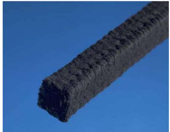
Uma combinação de fio acrílico e grafite, produzindo um empanque sintético econômico e versátil, adequado para serviços gerais em válvulas e bombas.
