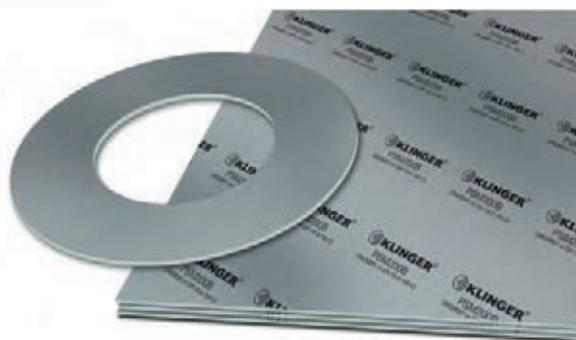
Composição: Grafite expandido com inserção de chapa em aço inoxidável perfurada de 0,1mm de espessura.
